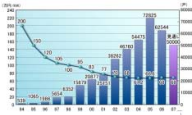
国内における住宅用太陽光発電の導入件数と kW あたり装置価格の推移（出典：太陽光発電協会資料）
